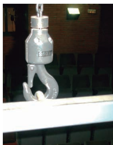
Riesgos de rotura de cáncamo en equipamiento escénico
