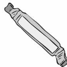
Figura 2. Ejemplo de absorbedor de energía como componente separado.
