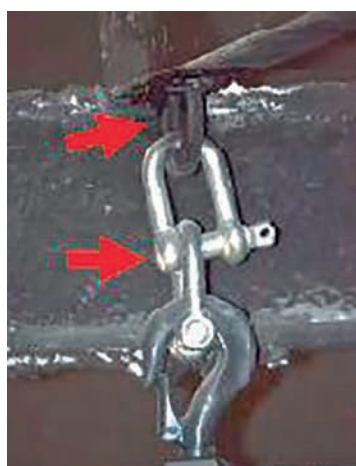
Errores de colocación de grilletes en equipos escénicos
