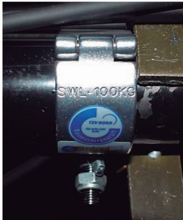
Identificación de la capacidad de carga en las garras de sujeción
