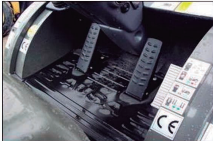
En el alquiler de carretillas debe verificarse que además de la documentación, existen las señalizaciones reglamentarias
