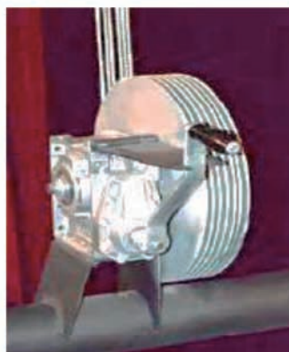
En los cabrestantes, se debe observar la existencia de sistema de autofrenado
